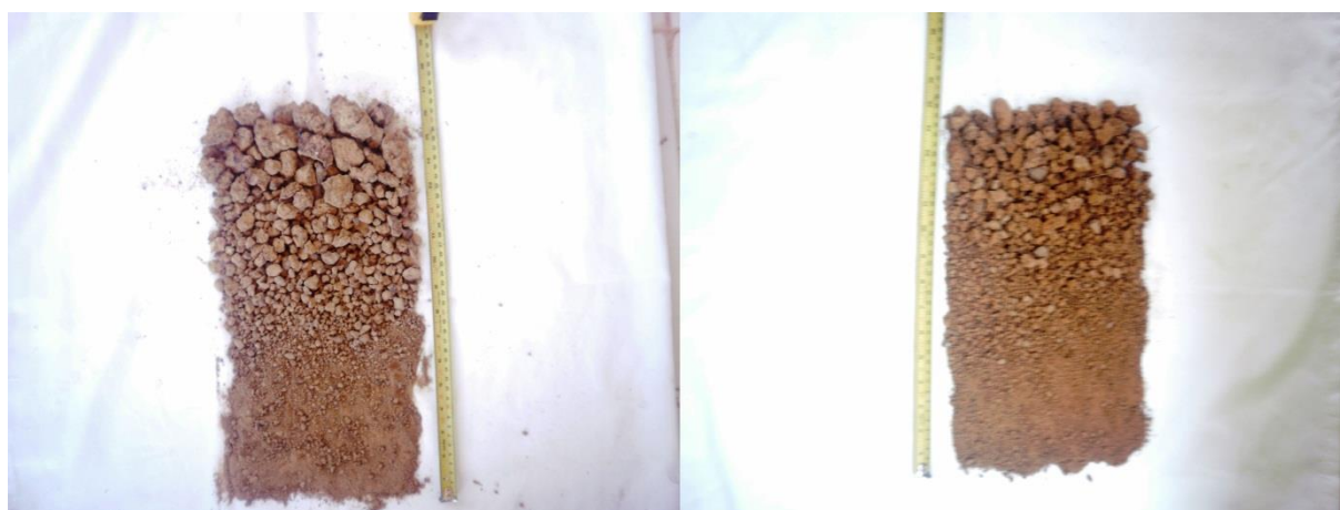
Figura 1 - Diferença da estabilidade de agregados. Esquerda Atividade Pastoril, Direita Floresta Secundária.
