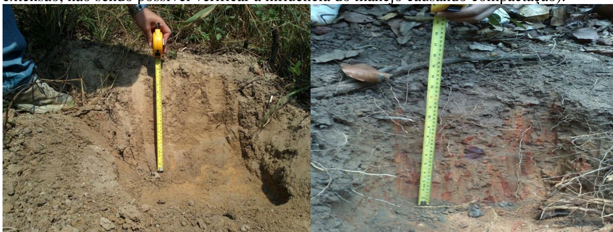
Figura 4 - Diferença entre as camadas compactadas. Direita Atividade Pastoril. Esquerda Floresta Secundária.
